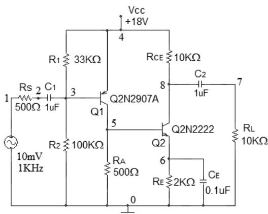
Fig. 1. Reference amplifier (PNP Sziklai pair).
