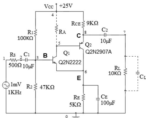
Fig. 2. Proposed amplifier (NPN Sziklai pair).
