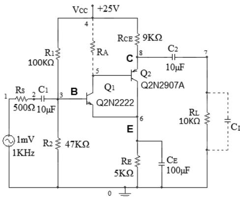
Fig. 2. Proposed amplifier (NPN Sziklai pair).
