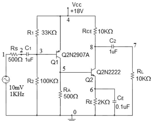
Fig. 1. Reference amplifier (PNP Sziklai pair).
